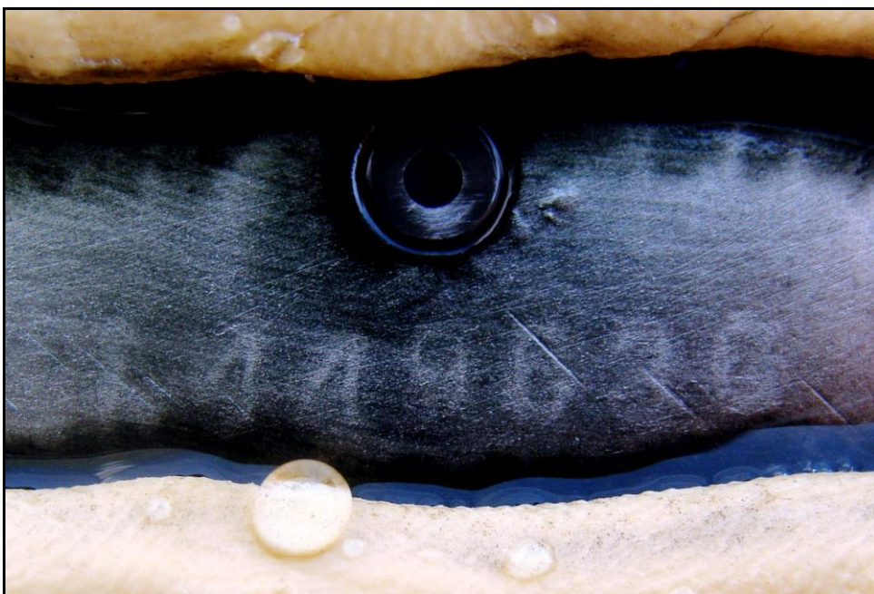
Рис. 2. Виявлене номерне позначення «L 449636» на ствольній коробці рушниці, після обробки хімічними реактивами.
