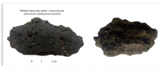
Рис. 1. Криця з території посаду літописного Путивля. Зовнішня поверхня та макроструктура зачищеної поверхні
